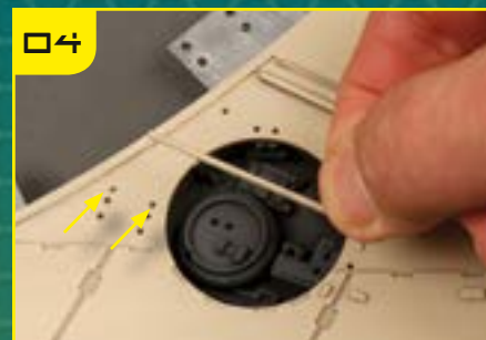
Вклейте штифты детали 3 в отмеченные отверстия, при этом конец детали должен размещаться в основании ниши.
