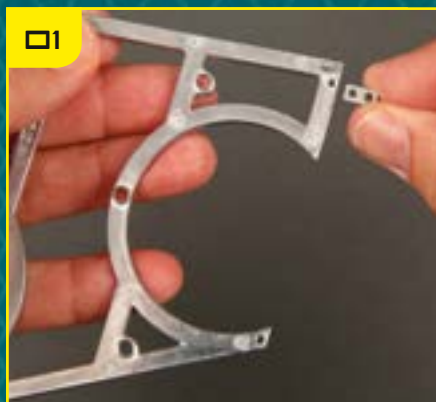
01 Установите соединительную накладку с двумя отверстиями на раму TF-45.
